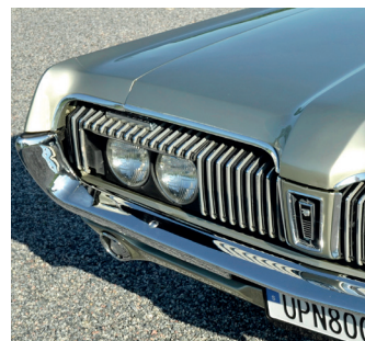
Simsalabim! Dolda strålkastare har varit inne till och från, de här var vakuumöppnade original men är konverterade till elektrisk funktion så nu öppnas locken på ett ögonblick.
