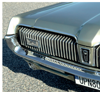
Simsalabim! Dolda strålkastare har varit inne till och från, de här var vakuumöppnade original men är konverterade till elektrisk funktion så nu öppnas locken på ett ögonblick.
